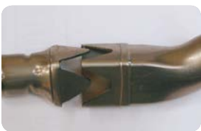
Konturschnitt Abgasanlage Contour cut of exhaust system
